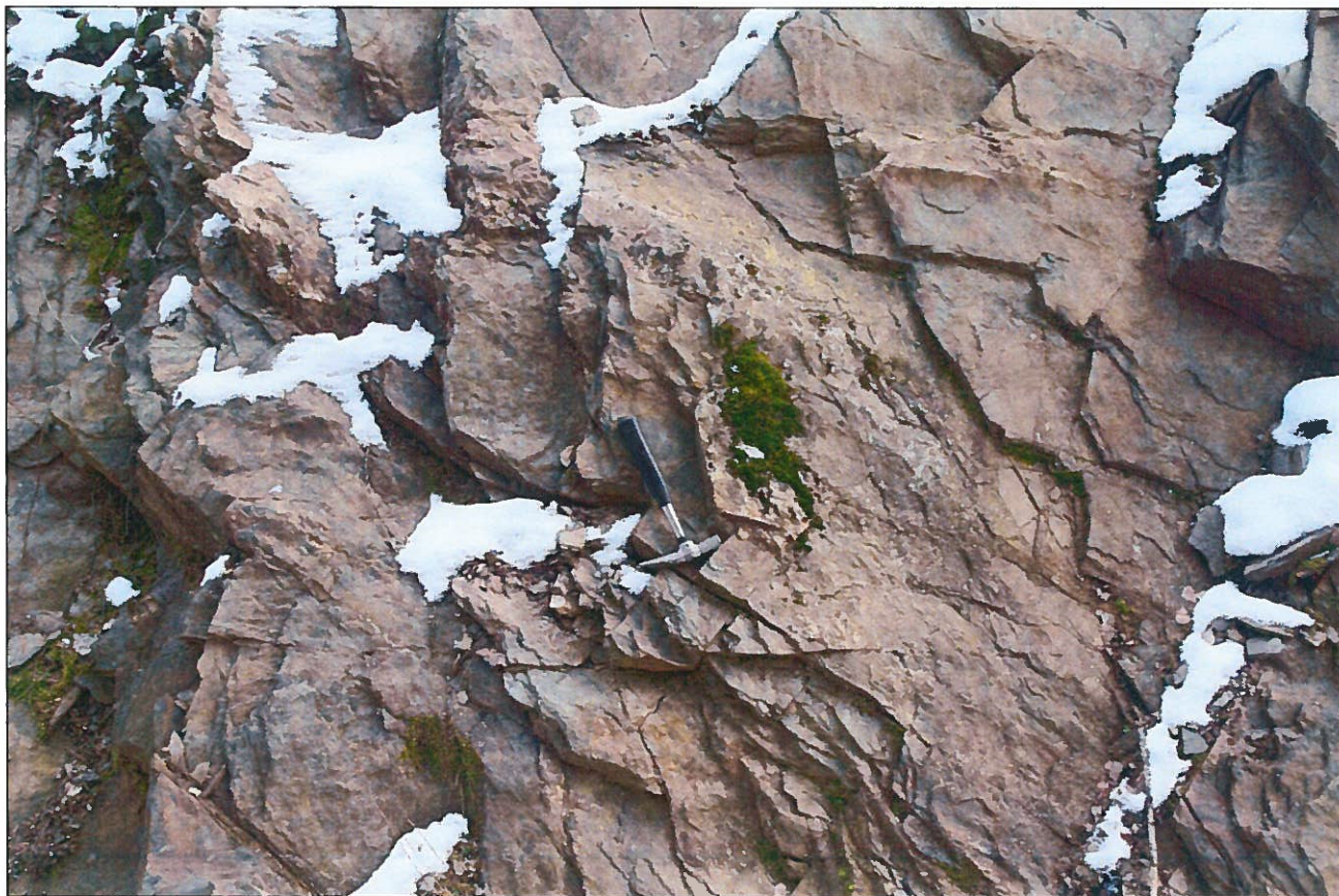
Foto – 7 Detail skalní stěny vpravo v km 26,400. Foliace je zcela zřetelná.
